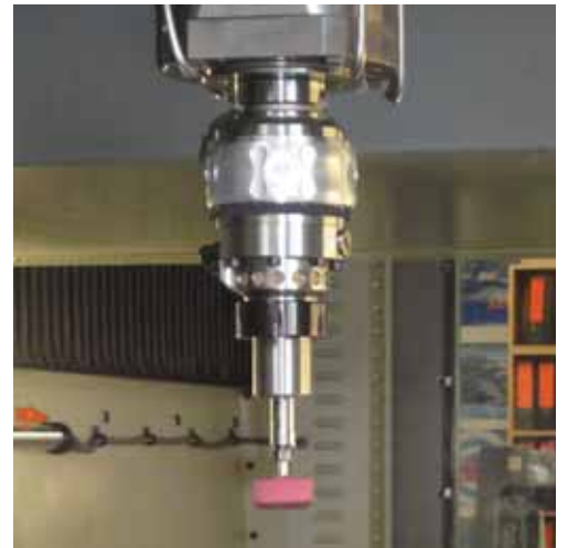
Örnek: İşleme merkezinde RSC sistemi
